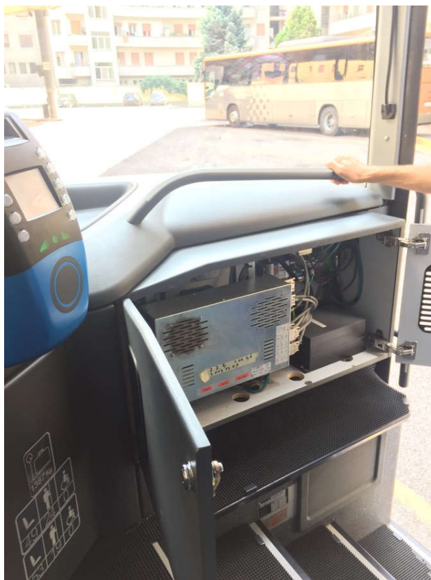
Figura 32: Box interfacce a bordo dei veicoli LiBUS dotati del sistema ITCS Telematrik.
