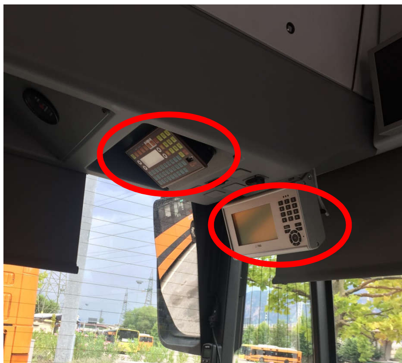
Figura 29: L'unità di controllo Aesys KC640 (a sinistra) e la console autista del sistema ITCS (a destra) su un veicolo SASA
