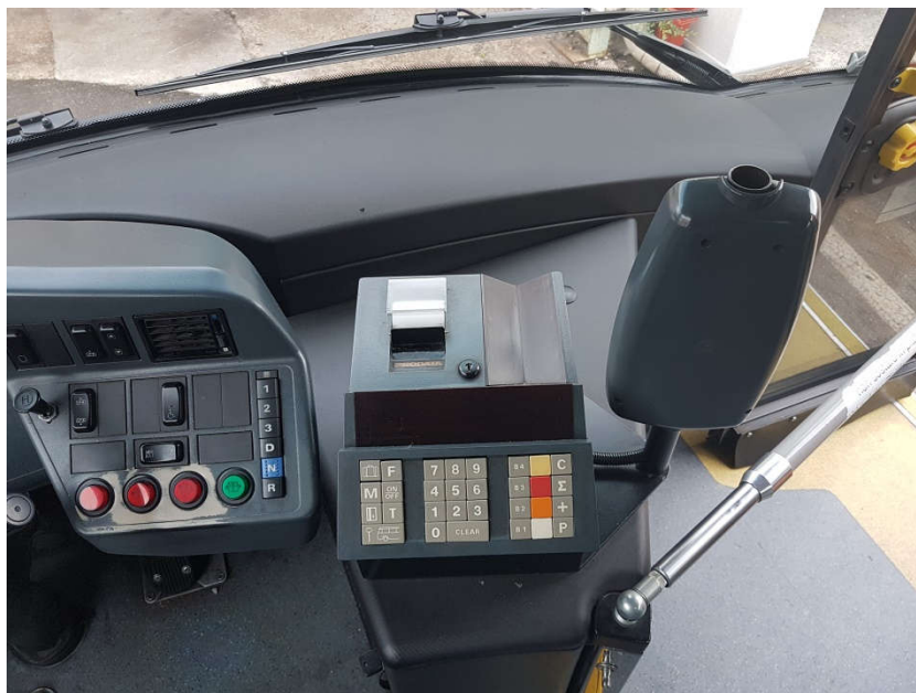
Figura 28: Posizione del conducente con vista sulla console del sistema di ticketing e sul supporto del validator.
