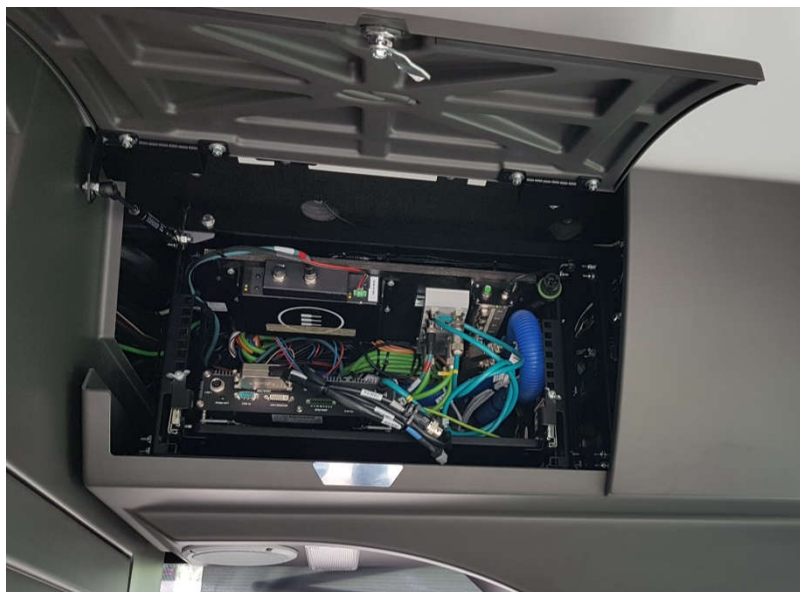
Figura 26: Vano tecnico per l'installazione delle componenti centrali del sistema di ticketing a bordo dei mezzi.
