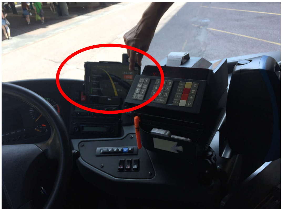
Figura 31: Tablet a bordo dei veicoli LiBUS dotati del sistema ITCS Telematrik.
